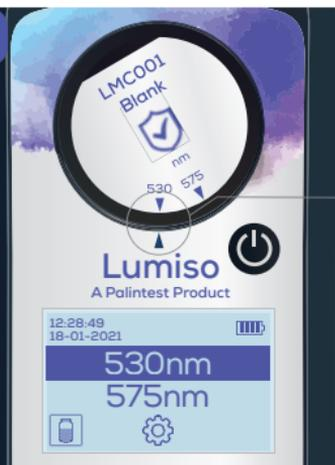
Asegúrese de que la longitud de onda que se está verificando esté alineada con la marca en el instrumento Lumiso.
