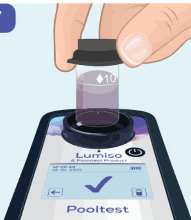
Prepare una muestra de 10 mL añadiendo reactivos según las instrucciones para pruebas. Coloque el tubo de ensayo en el soporte.
