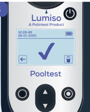
Esto indica que se completó correctamente la medición de la muestra en blanco.
