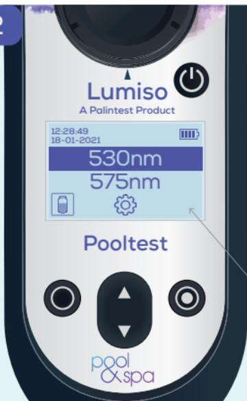
Se muestran las longitudes de onda de luz que utiliza el instrumento en nanómetros (nm).
