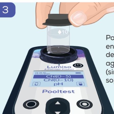
Para medir una muestra en blanco, coloque un tubo de ensayo que contenga agua de piscina o de "spa" (sin tabletas de prueba) en el soporte para tubos de ensayo.
