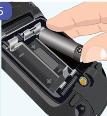
Inserte nuevas baterías de la misma manera, empujándolas hacia el contacto negativo, pero esta vez hacia abajo en el extremo positivo.
